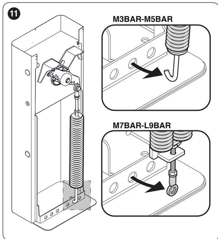
6. если нужно настроить маневр закрывания стрелы с правой стороны шлагбаума, разблокируйте электропривод (см. параграф «**Разблокируйте и заблокируйте электропривод вручную**») и поверните на 90° балансировочный рычаг
