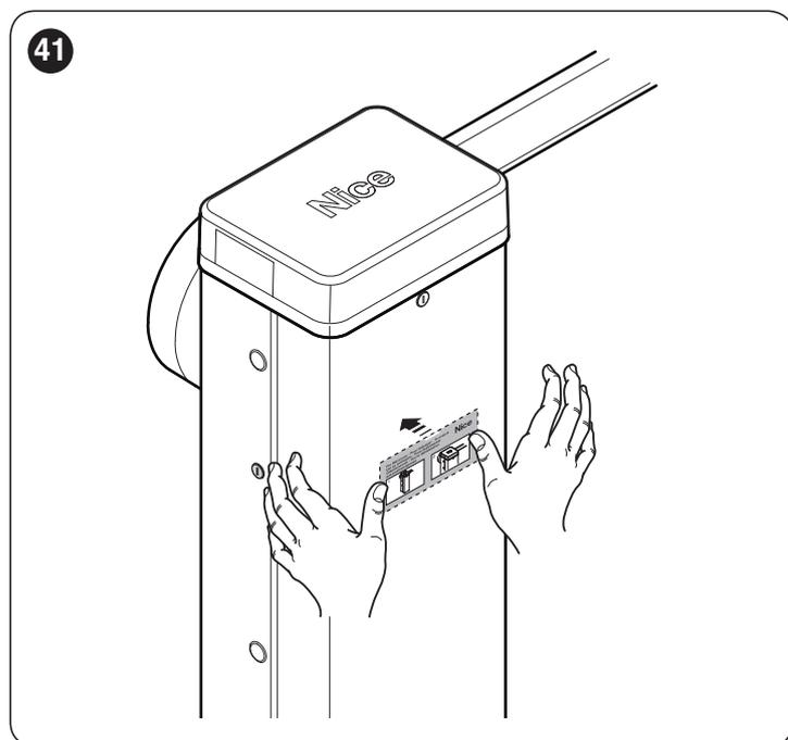
3. прикрепите к шлагбауму табличку со следующей информацией: тип системы автоматизации, название и адрес изготовителя (организации, выполнявшей ввод системы в эксплуатацию), серийный номер, год изготовления и знак «СЕ»
