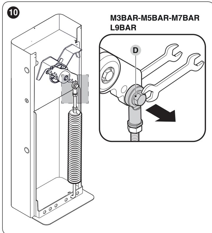
5. снимите пружину с плиты с отверстиями, расположенной у подножия шлагбаума
