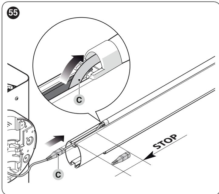
6. если необходимо, укоротите длину кабеля освещения; отрезать можно только в одной из точек, отмеченных специальным знаком. После того, как кабель обрезан, нужно снять заглушку, которая установлена на обрезанном конце, и закрыть ею образовавшийся конец
