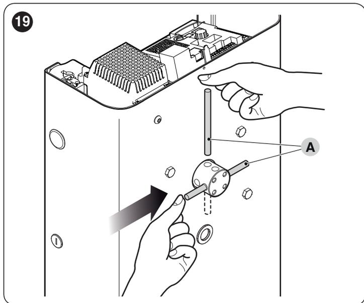
2. установите опору (В) на вал двигателя на выходе в положении «вертикальная стрела»
