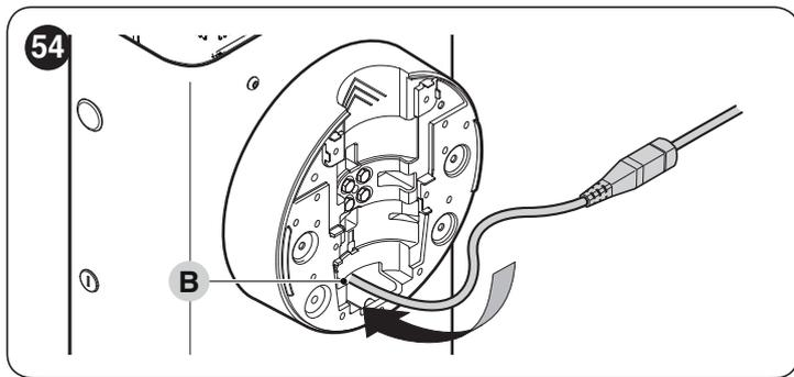
5. вставьте кабель освещения (C) в резиновую противоударную накладку, для облегчения этой процедуры можно использовать щуп
