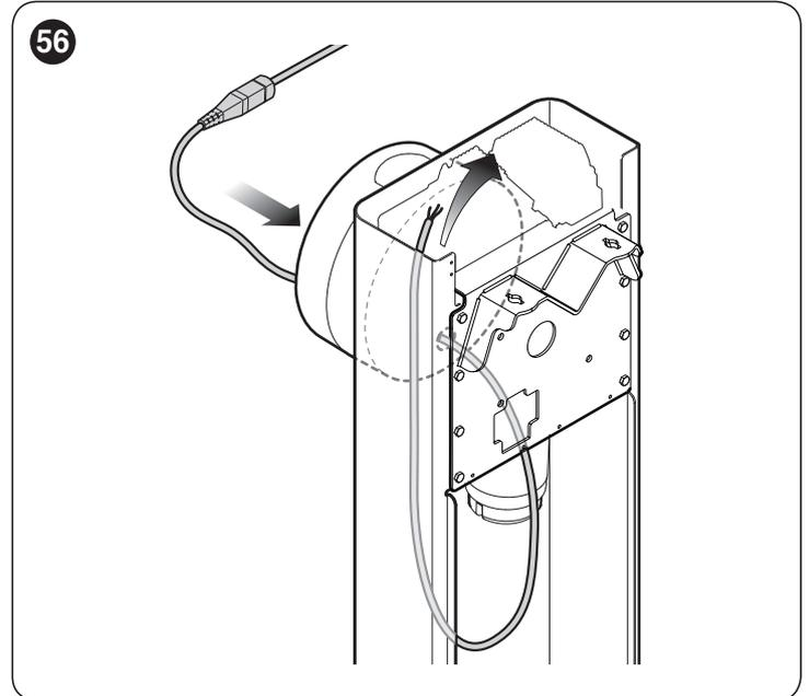
8. подключите кабель освещения к клемме «LIGHT» на блоке управления
