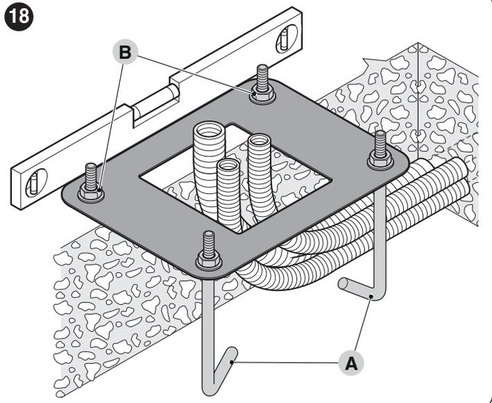
4. залейте бетон и, прежде чем он начнет скрепляться, установите на него опорную плиту параллельно шлагбауму, выравнивая ее идеально горизонтальное положение пузырьковым уровнем
