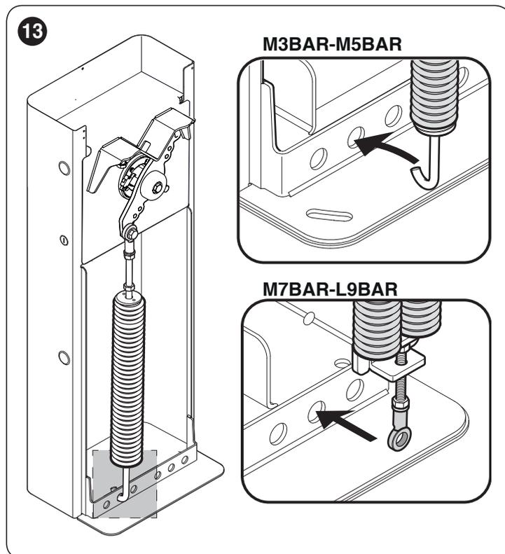
9. зафиксируйте ушко пружины на балансировочном рычаге, затянув до упора болт
