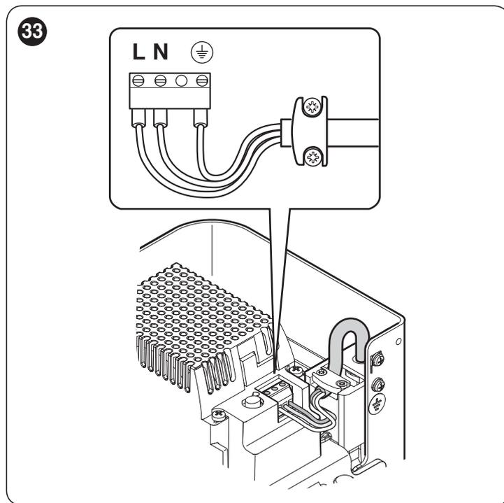
5. подключите оставшиеся кабели, руководствуясь электрической схемой на «Рисунке 34». Для большего удобства выполнения этой операции клеммы являются съемными.
